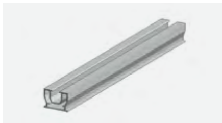
LAMBOURDE ALUMINIUM 35X25 mm Entraxe plots : 450 mm
